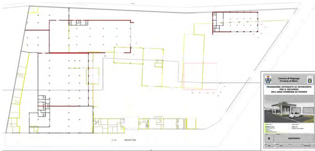
Figura 10 – Stralcio delle demolizioni e ricostruzioni
